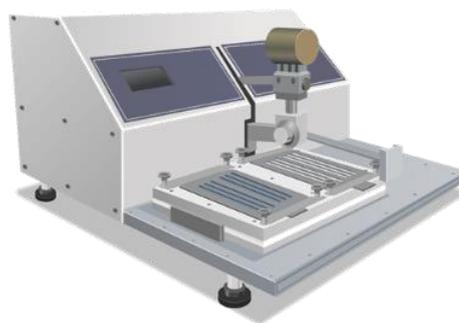
Beim Schnittfestigkeitstest der Norm EN 388:2003, dem sogenannten Coup-Test, bewegt sich ein Kreismesser über einem Material mit einer konstanten Kraft (5 N, also etwa 500 g) so lange hin und her, bis das Material zerschnitten wird. Der Test
